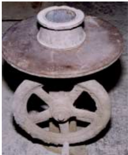
写真 - 1 フローコーンの設置
