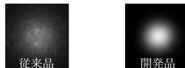
Fig.1 波長変換部材発光面の輝度プロファイル
