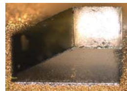
図 4 プリズムと窒化アルミ基板との接合の様子
