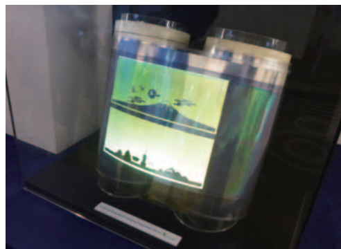
G-Leaf®を使用した有機EL照明デバイス (ドイツFraunhofer FEPとの共同開発)
