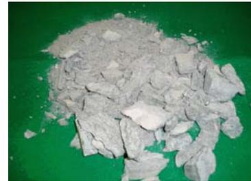
写真2 GRC破碎品(歯開き15mm)
