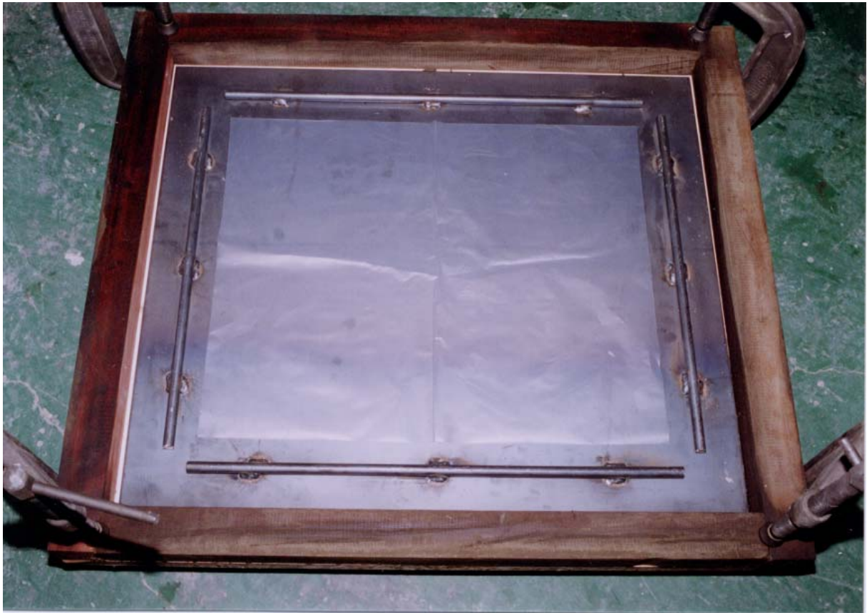
写真1 拘束用鉄板を設置した型枠
