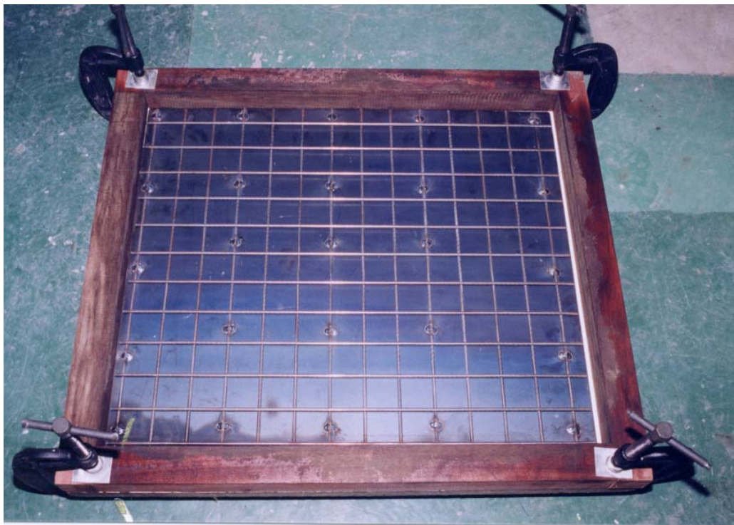
写真1 拘束用メッシュを溶接した鉄板を設置した型枠
